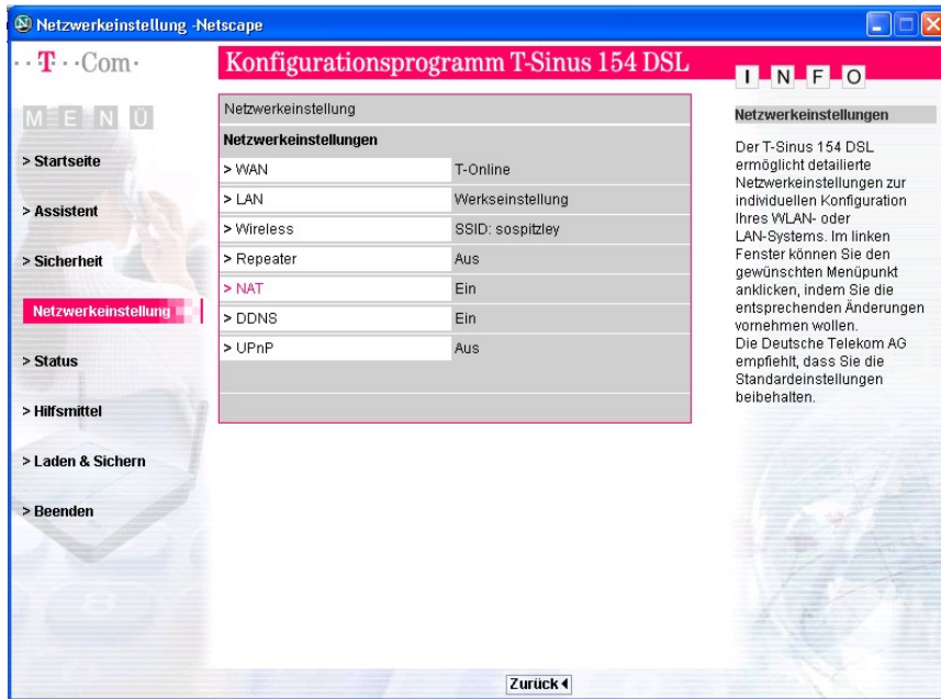
Abbildung 14: Konfiguration des Routers mit NAT
